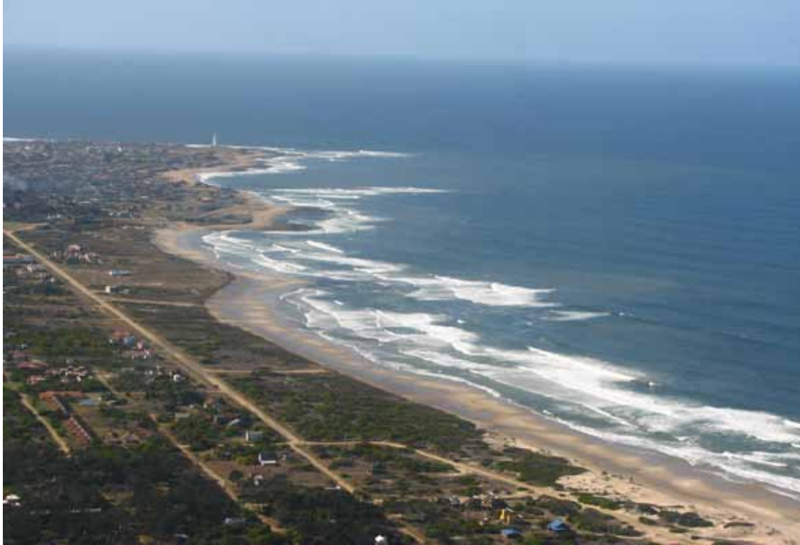
Foto aérea de un sector del balneario La Paloma, el balneario más importante de Rocha. Se puede apreciar la urbanización hasta el borde de la playa y la desaparición del sistema dunar. Como consecuencia, la playa pierde la reserva de arena, se erosiona y el mar avanza. Se puede apreciar la humedad en toda la playa, producto de la pérdida de arena superficial. Foto: gentileza de Héctor Caymaris.
